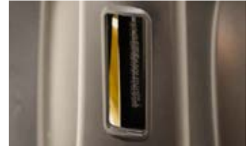
Chassinummer är stämplat på ramen framför förararen.
